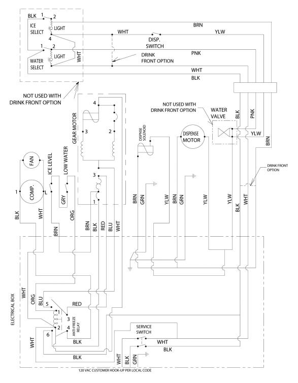
Figure 17. Schematic IMD 300-30, IMD 600-30, IMD 601-30, IMD 600-90 and IMD 601-90
