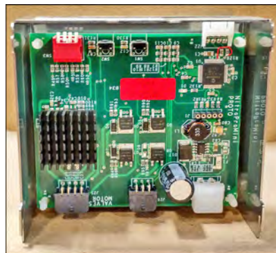
Figura 6-1 Alojamiento de la PCB principal extraído
