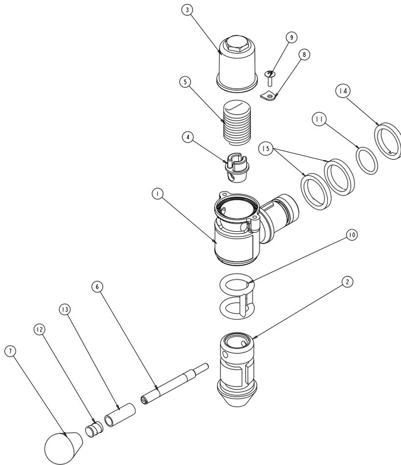
Figura 5. Montaje de La Válvula de Motorman
