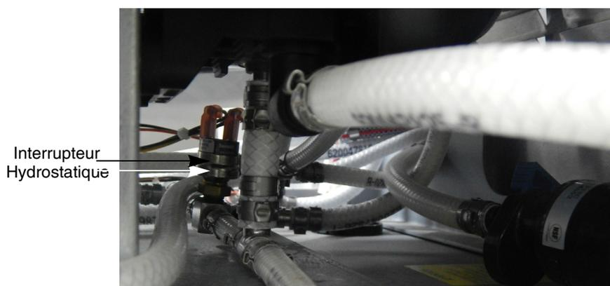
**Figure 51. Vue de l'interrupteur hydrostatique**
