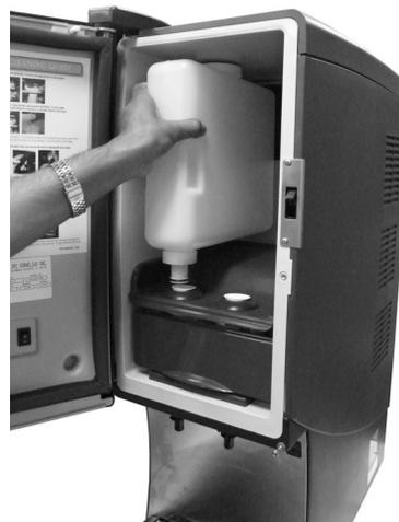
Figura 4. Carga de un recipiente de concentrado
